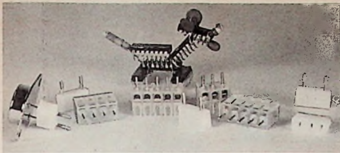
Afb. 4. Nieuwe hulpmiddelen: Plastic opstekers voor TO3 transistoren met metalen pennen, kroonstrippen in plastic omhulning voor printmontage – één zijde is gesloten, verschillende lengten. Het IC-beest kijkt belangstellend toe!
