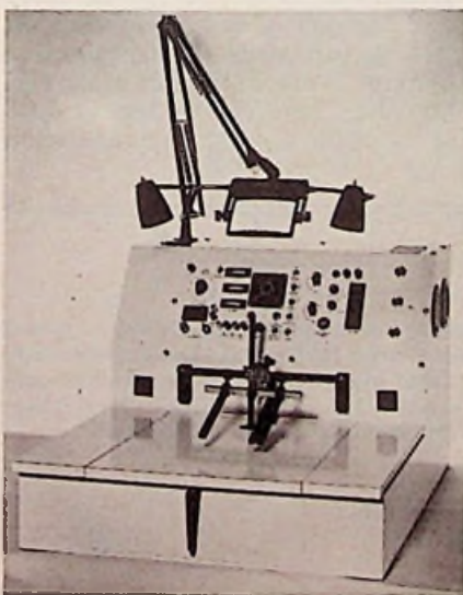
Afb. 5 Compleet uitgeruste herstel- en productie-eenheid, gemonteerd op verrijdbaar ladenkastje.
